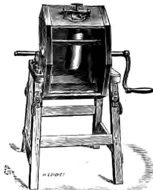
5. — Baratte rotative polygonale munie d'une chambre pour réchauffer ou refroidir la crème.
